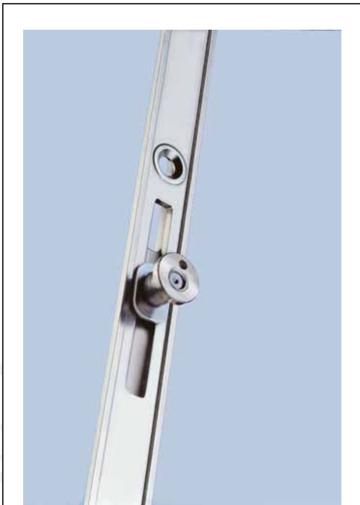
Regulación Bulón V Regulación presión lateral y altura de +/-0,8 mm
